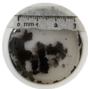
Рис. Надпись «Film» в виде тонкой пленки (~200нм), произведенная на границе раздела «ГНЖ — октан» при помощи разработанной технологии управляемого роста
