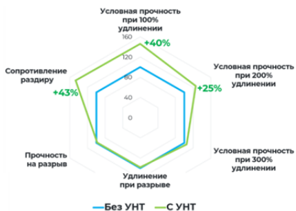
Рис. 2. Влияние МУНТ на физико-механические свойства резин на основе SBR; концентрат на основе МУНТ производства ИК СО РАН
